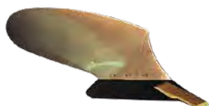
Винтообразный цилиндрический отвал N (от 15 до 30 см)
